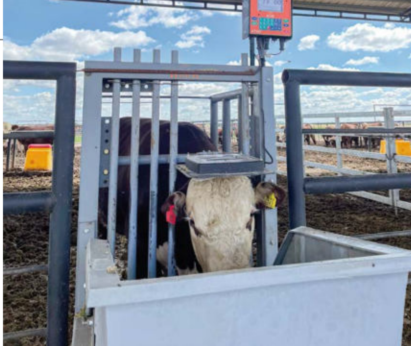
Comedero inteligente para medición de consumo individual.
